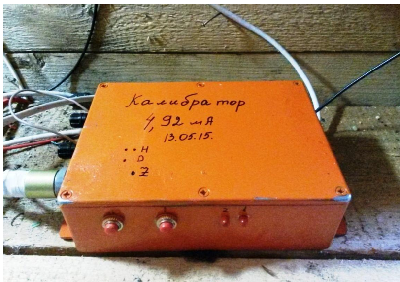
Рисунок 3 – Установленный автоматический калибратор на магнитной станции «Байгазан»
